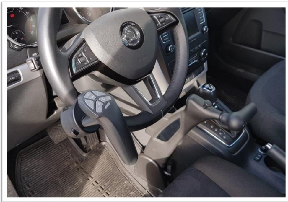
Rys. 2. Wnętrze pojazdu Skoda Yeti – uchwyt z funkcją pilota
