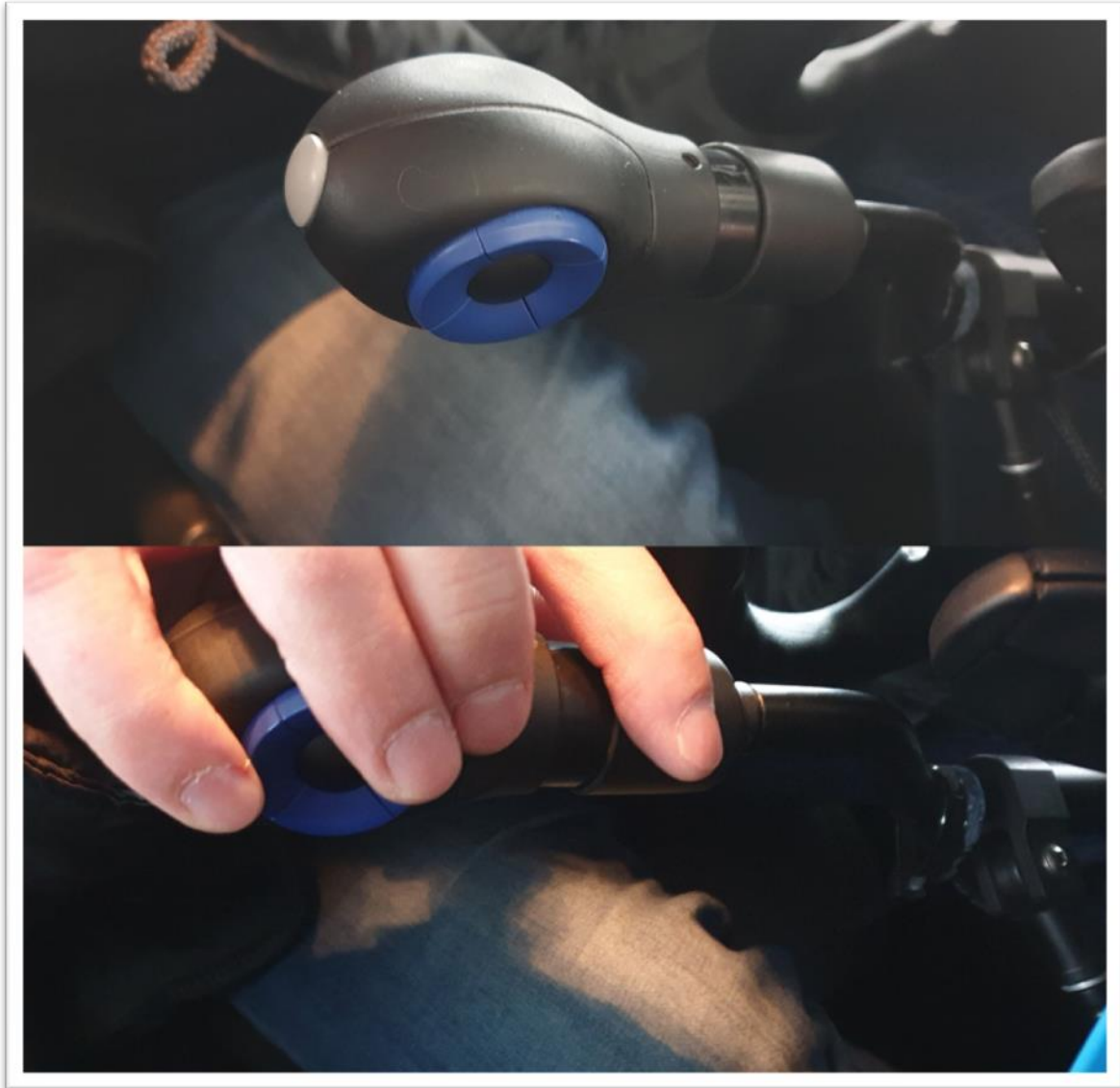
Rys. 7. Wnętrze pojazdu Peugeot Partner – rękojeść (pilot) urządzenia ręcznego gazu-hamulca
