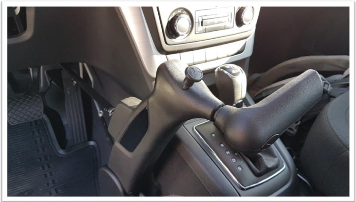
Rys. 3. Wnętrze pojazdu Skoda Yeti – ręczny gaz-hamulec
