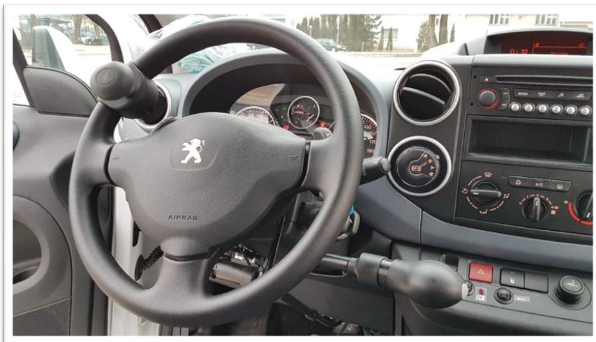
Rys. 6. Wnętrze samochodu Peugeot Partner wyposażonego w uchwyt w formie gałki i elektromechaniczny gaz-hamulec
