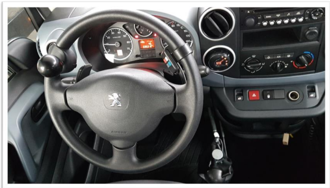
Rys. 4. Wnętrze pojazdu Peugeot Partner z uchwytem na kierownicy i mechanicznym gazem-hamulcem
