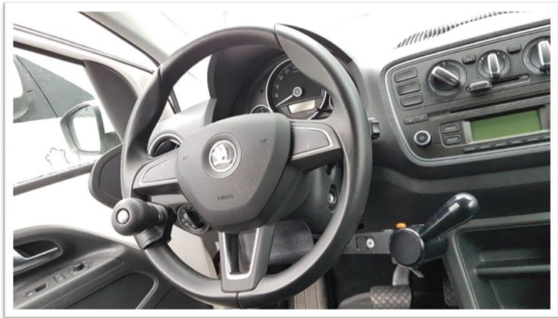
Rys. 8. Wnętrze pojazdu Skoda Citigo wyposażonego w gałkę i elektromechaniczny gaz-hamulec
